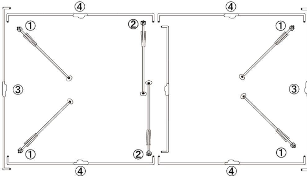
(3)鉄骨を組みます。柱(①・②)にある3つもしくは4つある穴のうち、左右にある穴に梁(③・④)を差し込み、土台を組みます。先に屋根部分を組み、柱(①・②)の一番外側の穴に合掌(⑤)を差し込みます。
